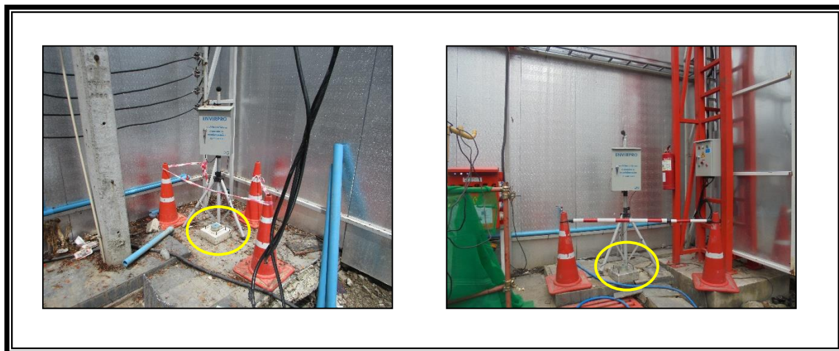
รูปที่ 3.3-1 จุดตรวจวัดความสั่นสะเทือน บริเวณภายในพื้นที่ก่อสร้างโครงการใกล้กับคาเฟ่ เดอ ทองหล่อ ความสูง 1 ชั้น
